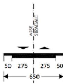
Figura 5 - Sezione tipo
