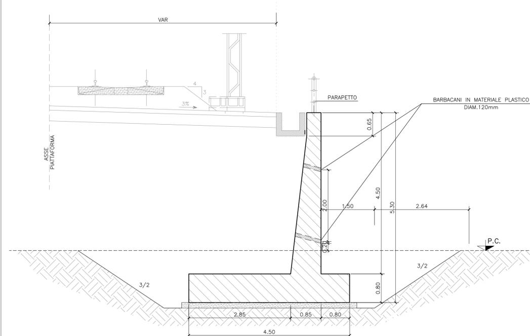
**SEZIONE TIPO MURO DI LINEA**
