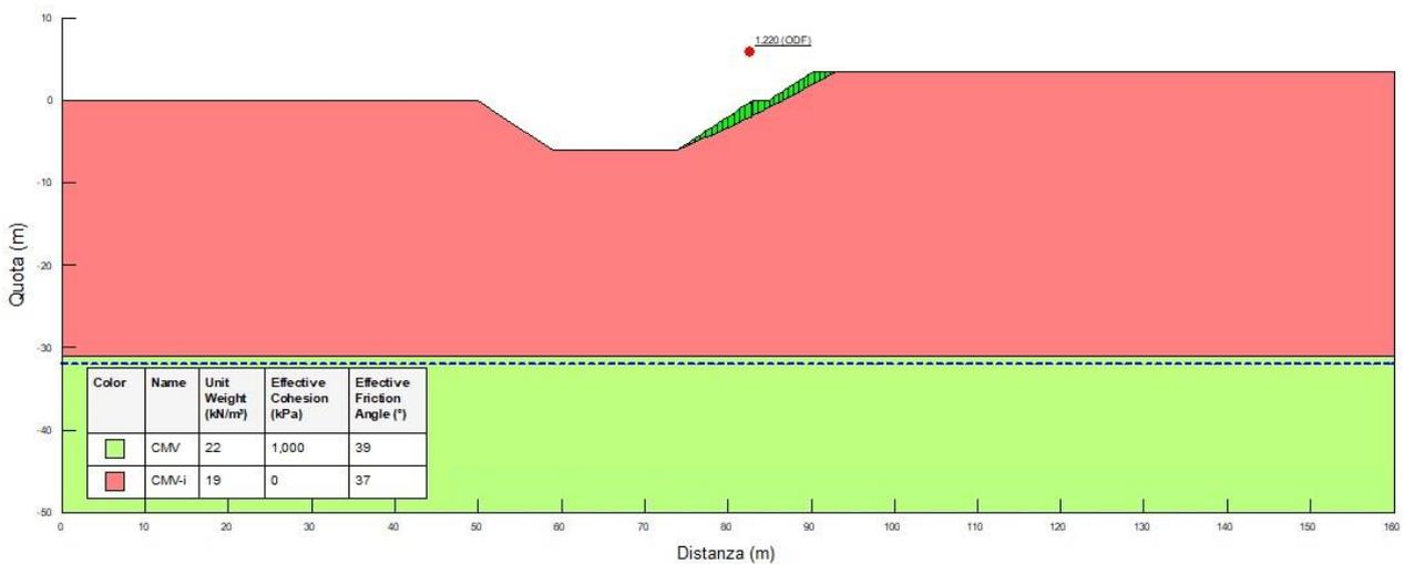
**Figura 8 - Sezione tipo T1: risultati dell'analisi di stabilità globale in condizioni sismiche**
