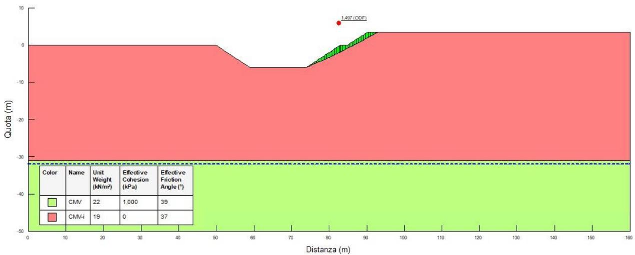
**Figura 7 - Sezione tipo T1: risultati dell'analisi di stabilità globale in condizioni statiche**
