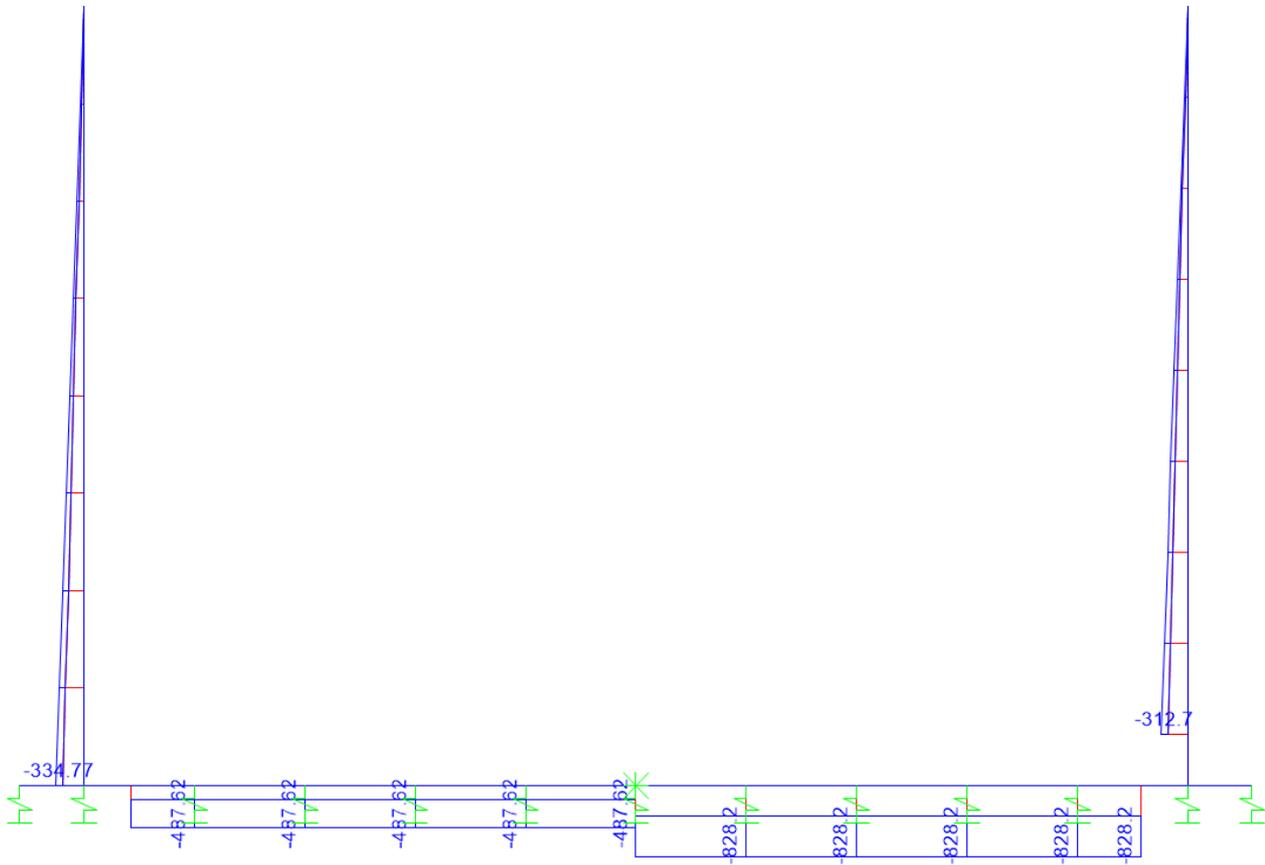
*Figura 11: Sforzo Normale – Involuppo SLU (kN)*
