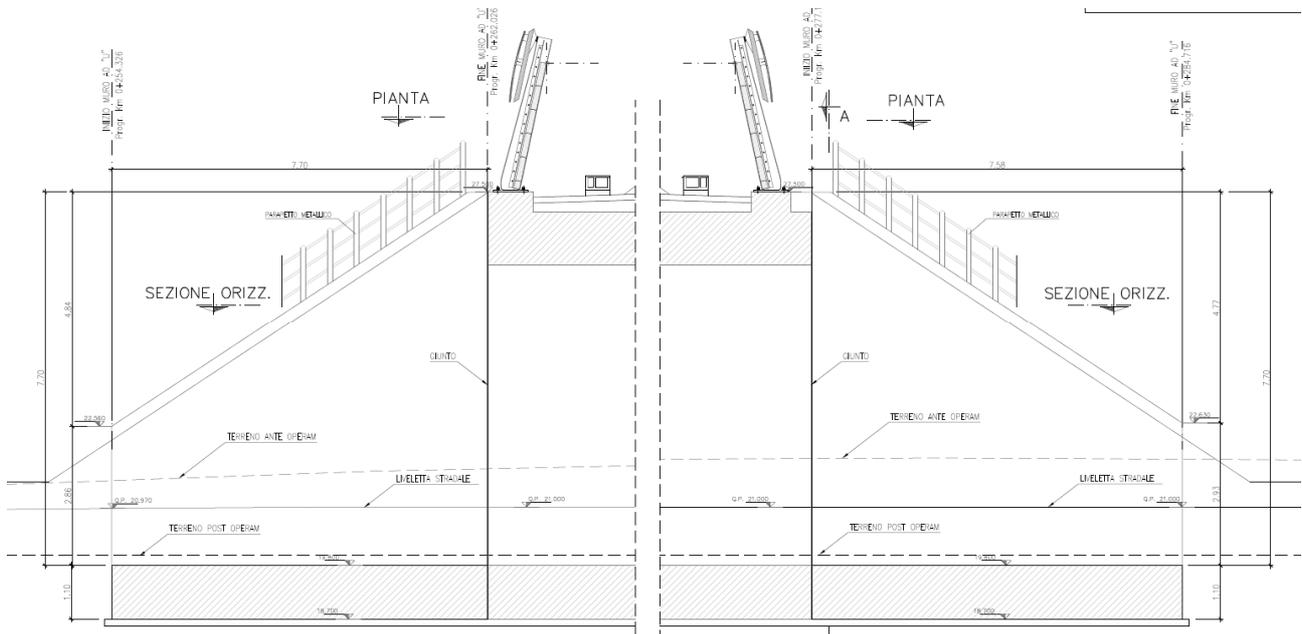
Figura 7: Muri di sbocco/imbocco - Sezione longitudinale
