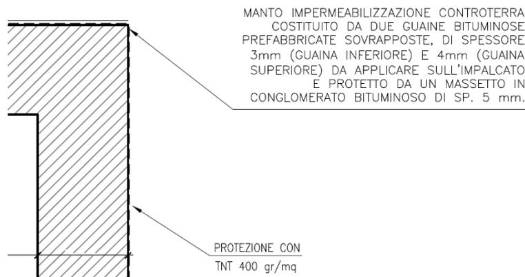
*Figura 10: Impermeabilizzazione superiore del sottovia*
