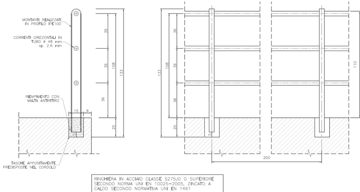
*Figura 9: Parapetto metallico*
