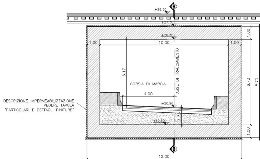
*Figura 4: Scatolare - Sezione trasversale*
