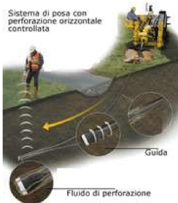
Figura 7 - Schema di sottopasso di un corso d'acqua mediante tecnologia TOC.
