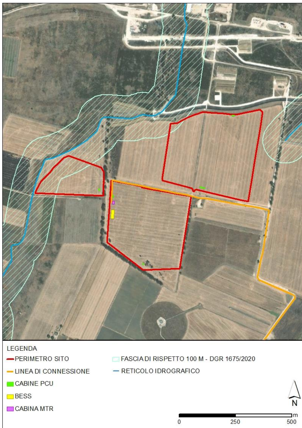
Figura 5.1: Componenti idrologiche – fascia di rispetto per i corsi d’acqua non iscritti al registro delle acque pubbliche
