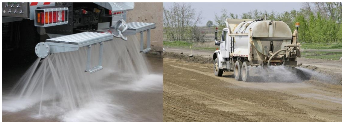
Figura 5-7: Automezzo per la bagnatura delle piste sterrate
