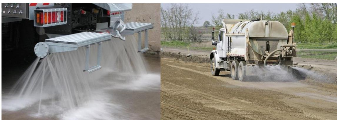
**Figura 5-7: Automezzo per la bagnatura delle piste sterrate**
