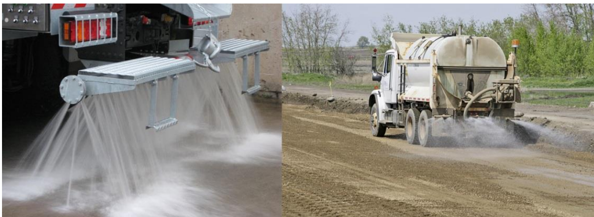
Figura 8-2: Automezzo per la bagnatura delle piste sterrate
