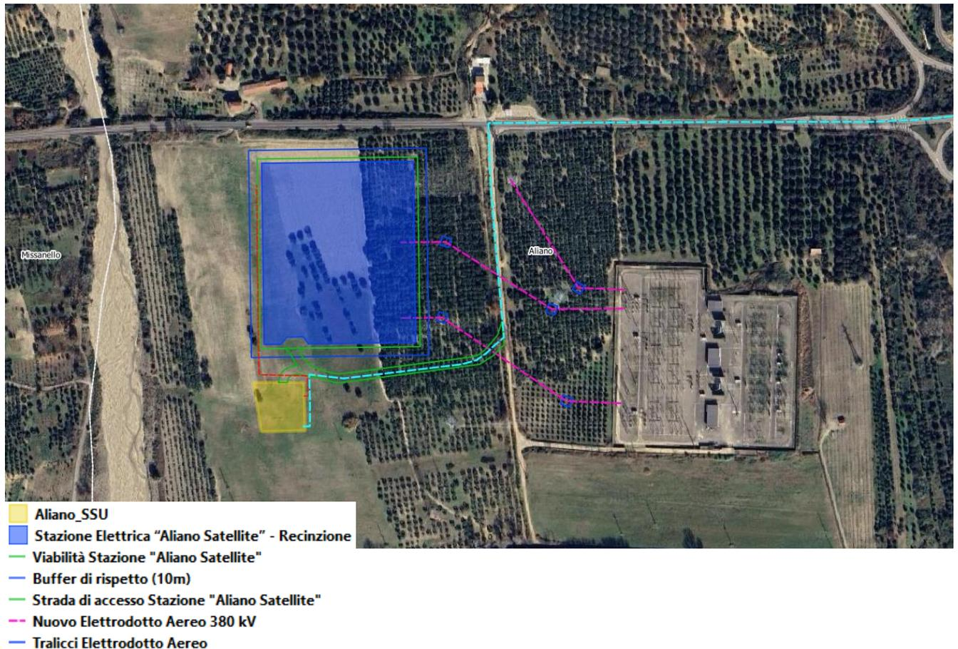
**Figura 2-5: Ortofoto area di futura Stazione elettrica utente adiacente al futuro ampliamento della Stazione Terna "Aliano Satellite"**
