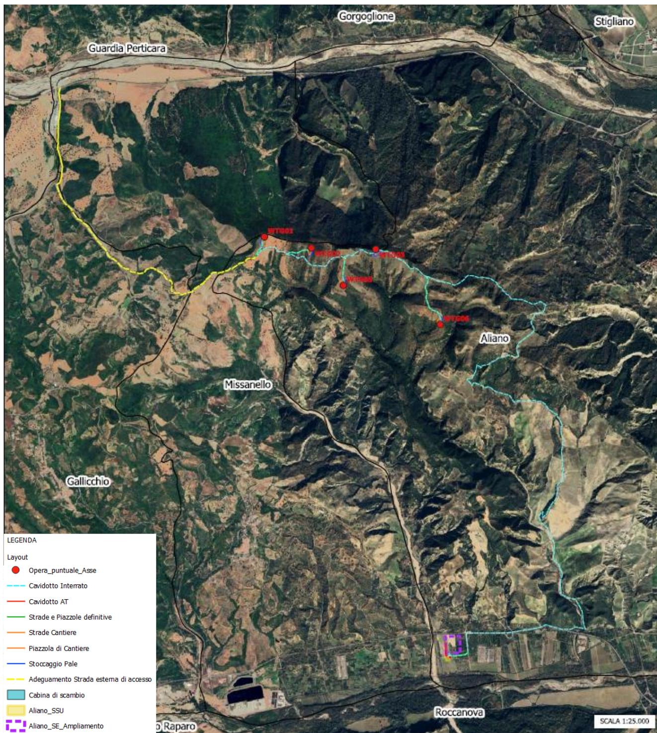
**Figura 20: Layout parco eolico e opere di connessione**
