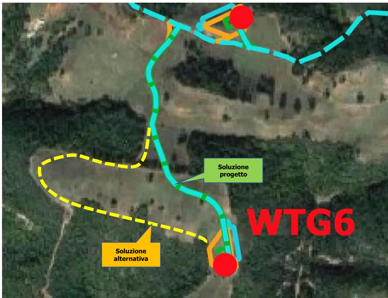
Figura 12-5: Analisi alternative strada interna di accesso alla turbina 6
