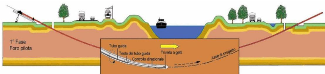
**Figura 2** Schema della fase di realizzazione del foro pilota.
