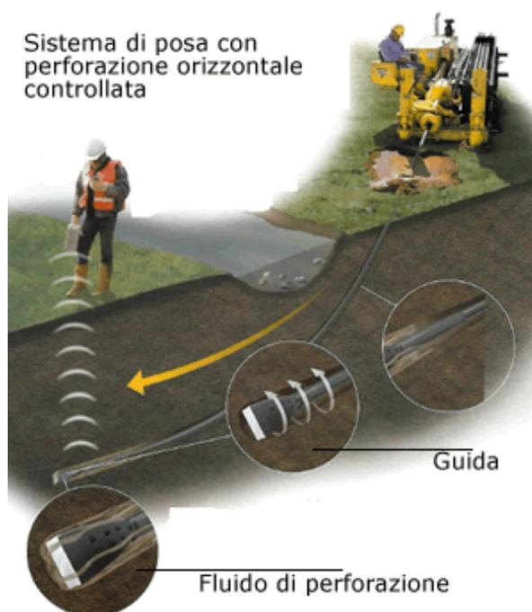
**Figura 1- Sistema di trivellazione orizzontale controllata (T.O.C.)**
