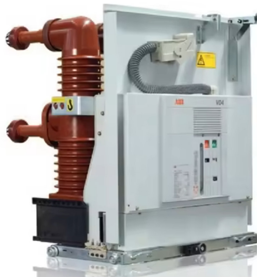
Figura 4: Modulo di interruzione con sezionatore isolato in SF6 e Interruttore in Vuoto
