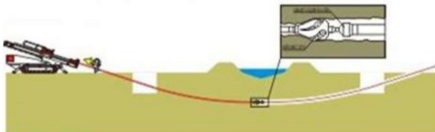
Figura 22 – Seconda fase della tecnica di Trivellazione Orizzontale Controllata: alesatura
