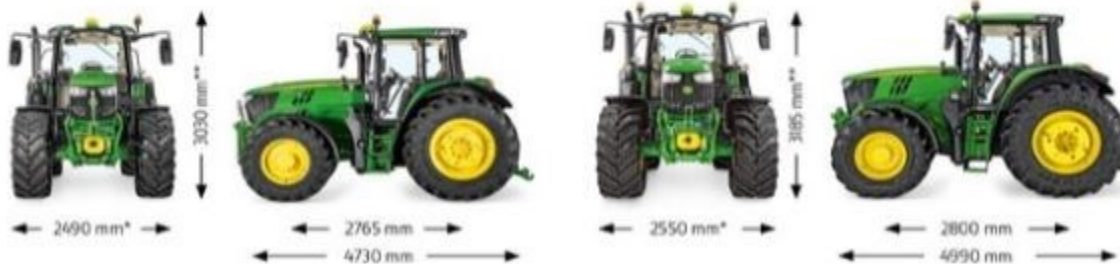
Fig. 24 - Trattrice gommata John Deere potenza 100/120 cv
