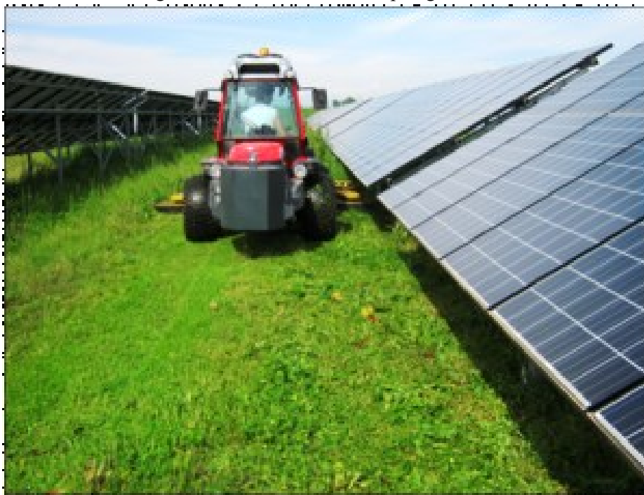
Fig. 43 - Lavorazione delle macchine agricole su campo agrivoltaico a tutto campo
