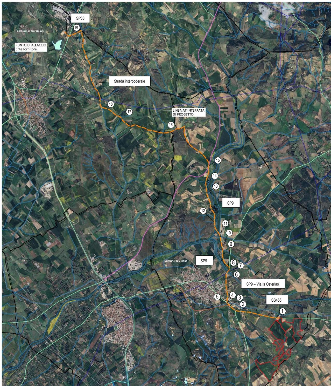
Figura 5: Percorso cavidotto e le interferenze rilevate
