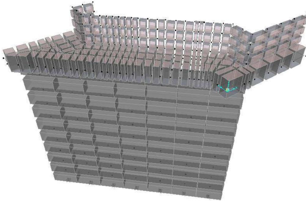
*Modello di calcolo Spalla*
