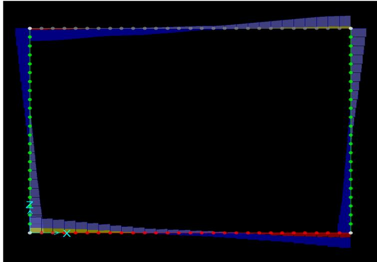
DIAGRAMMA DELLE DEFORMAZIONI (STR1-Effetto amplificato)
