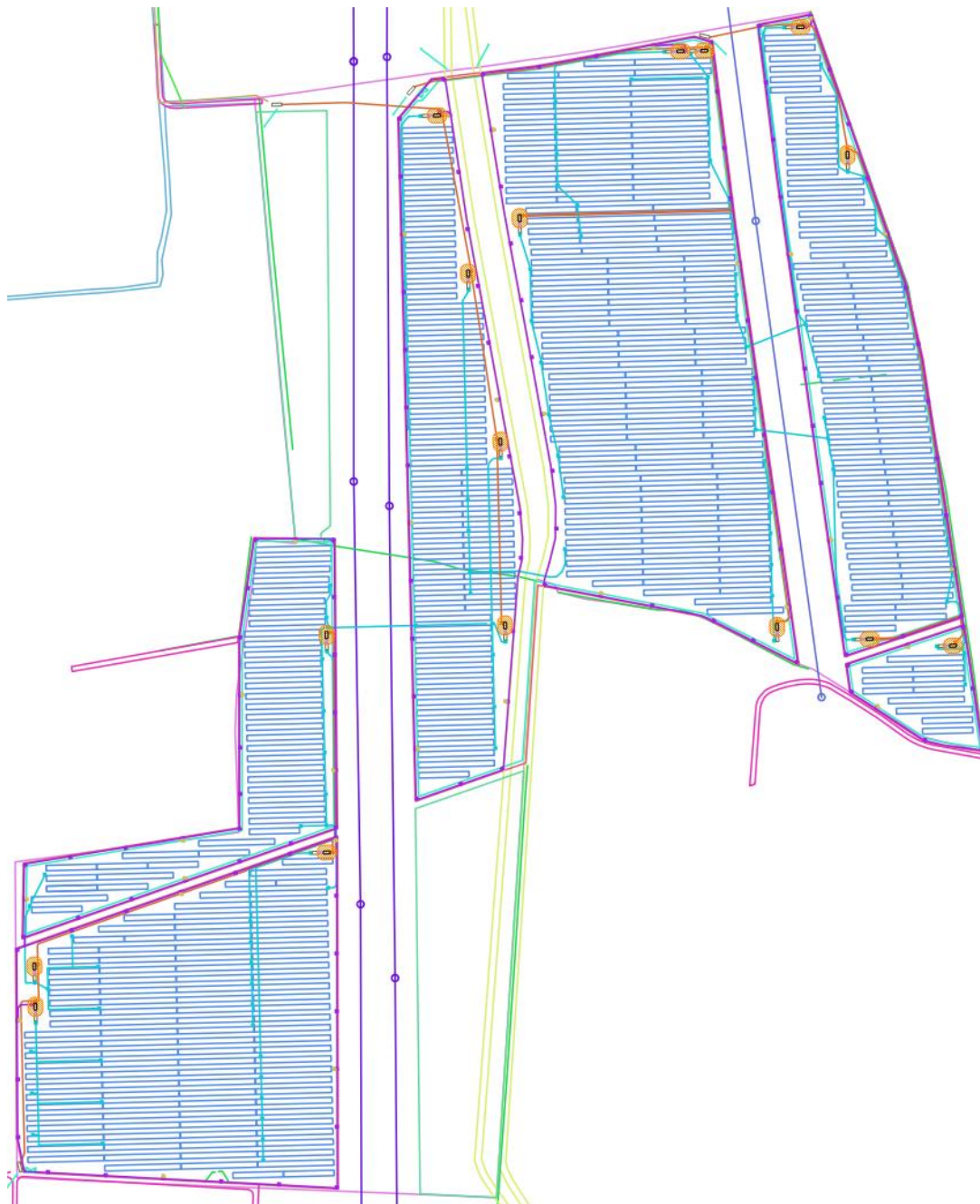
Figura 8 DPA rilevanti a seguito della valutazione nelle 16 cabine di trasformazione e 16 linee BT
