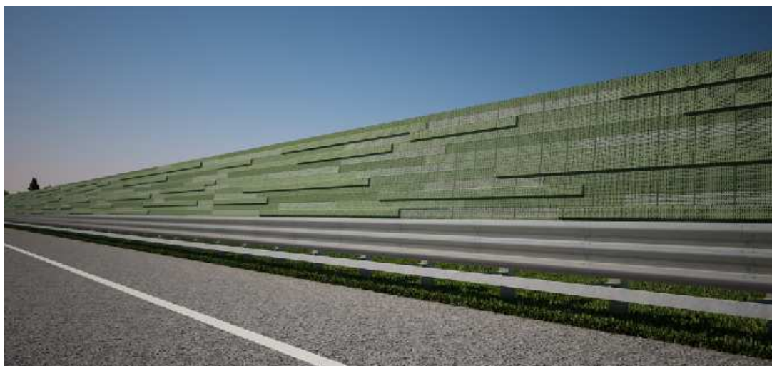
FIGURA 2.4-9 ESEMPIO DI PROTEZIONI ANTIFONICHE OPACHE, SIMULAZIONE DELLE FINITURE LATO SORGENTE
