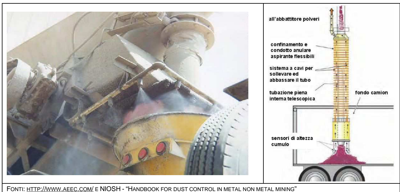
FIGURA 4.3-15 – ESEMPI: COLLETTORE AD UGELLI SPRAY APPLICATO AL PUNTO DI CARICO DI UNA BETONIERA, TUBAZIONE DI CARICO TELESCOPIZZATA CON SISTEMA DI ASPIRAZIONE LOCALIZZATA E SENSORE DI PROSSIMITÀ.
