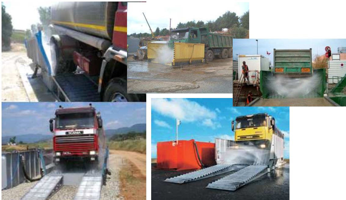
FIGURA 4.3-9 – SISTEMI DI LAVAGGIO DEI PNEUMATICI A PRESSIONE.
