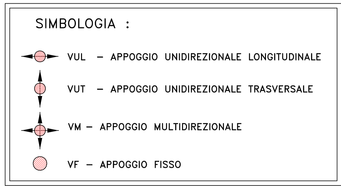
SCHEMA APPARECCHIO D'APPOGGIO SCALA 1:50
