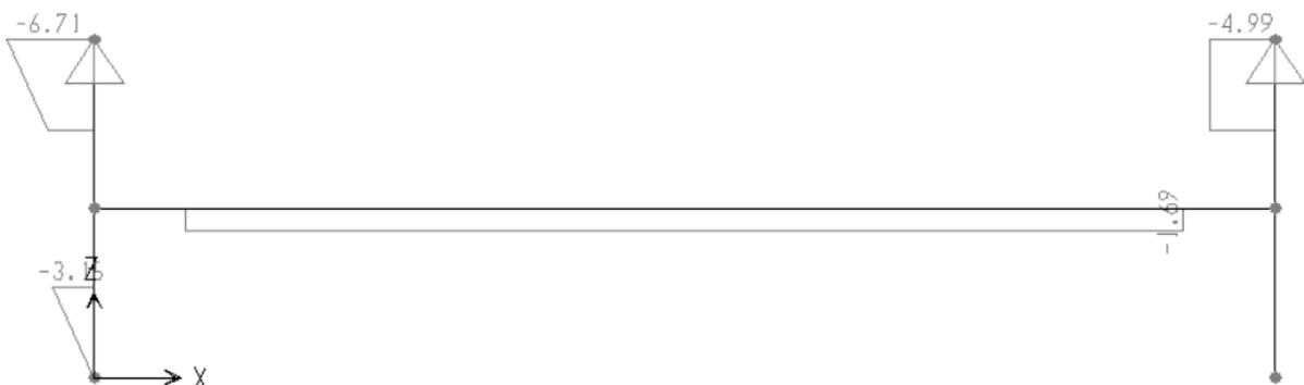
Figura 6.12. Trasverso di campata – Sforzo di taglio SLU
