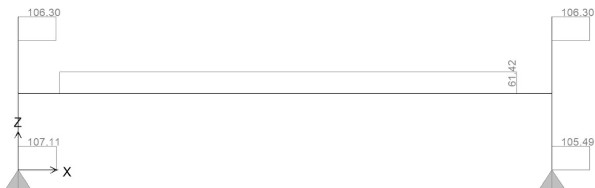
Figura 6.17. Trasverso di appoggio spalla – Sforzo di taglio Ht-vento
