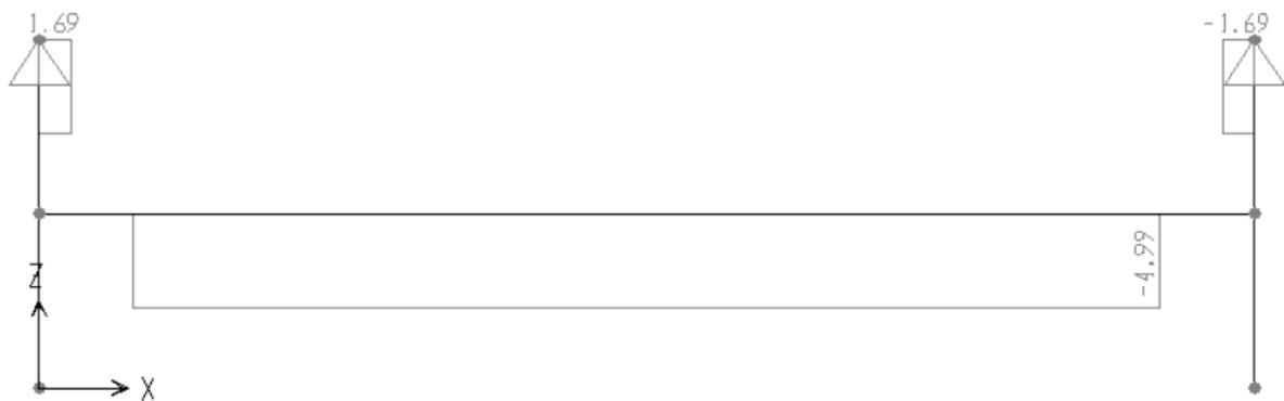
Figura 6.11. Trasverso di campata – Sforzo normale SLU
