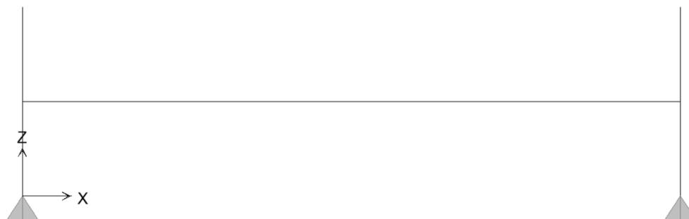
Figura 6.13. Modello di calcolo - Trasverso di appoggio – spalla
