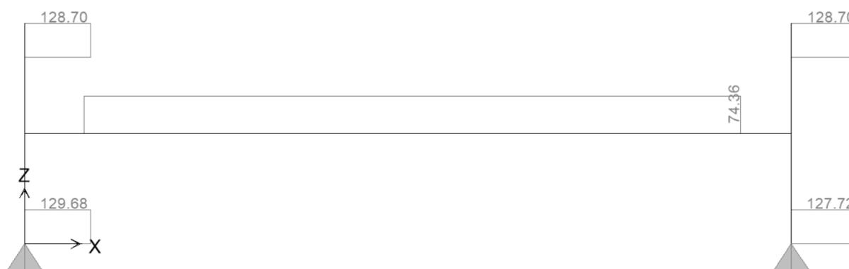
Figura 6.15. Trasverso di appoggio spalla – Sforzo di taglio  $H_t\text{-SLV}$
