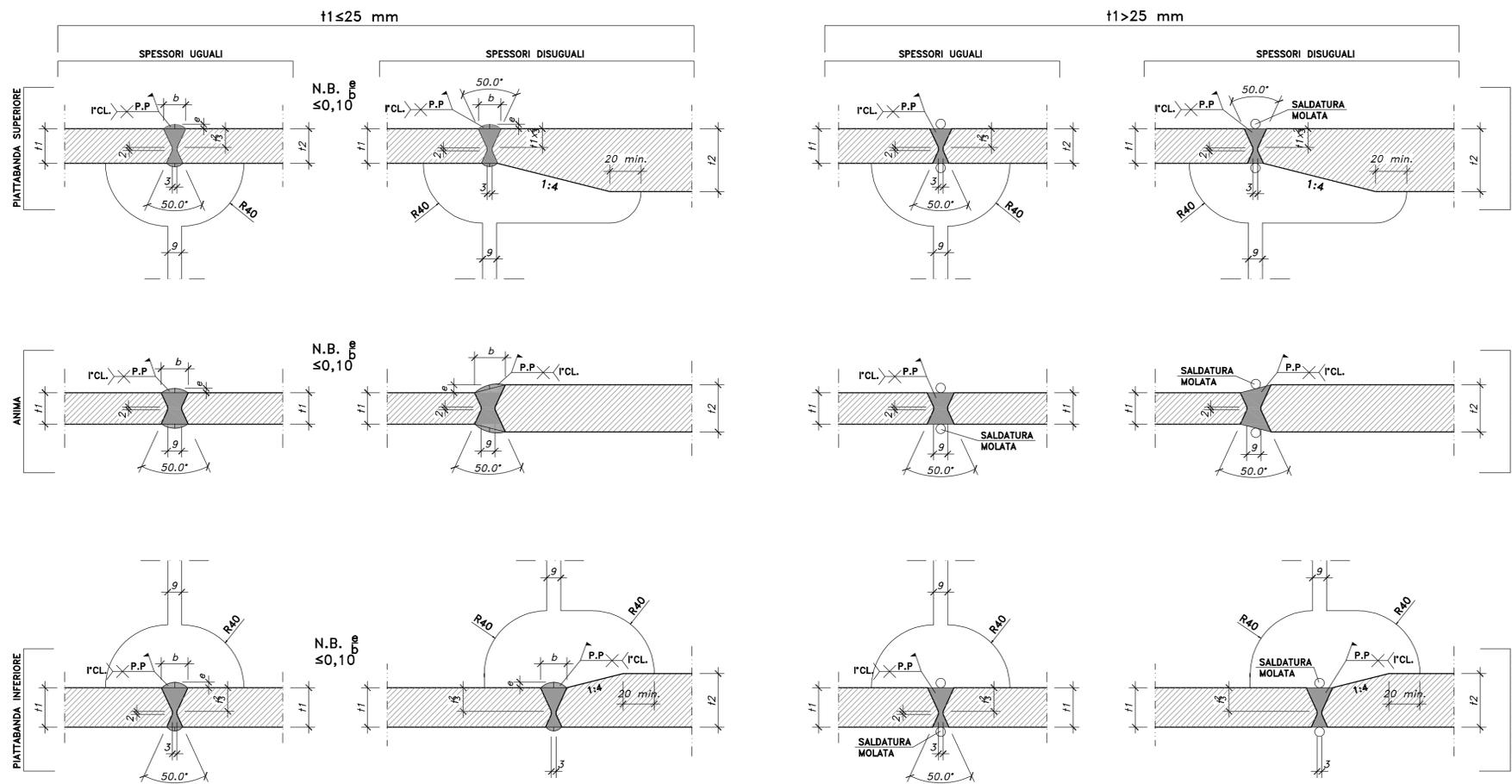
PARTICOLARE ESECUZIONE SALDATURE PIASTRE IMPILATE
