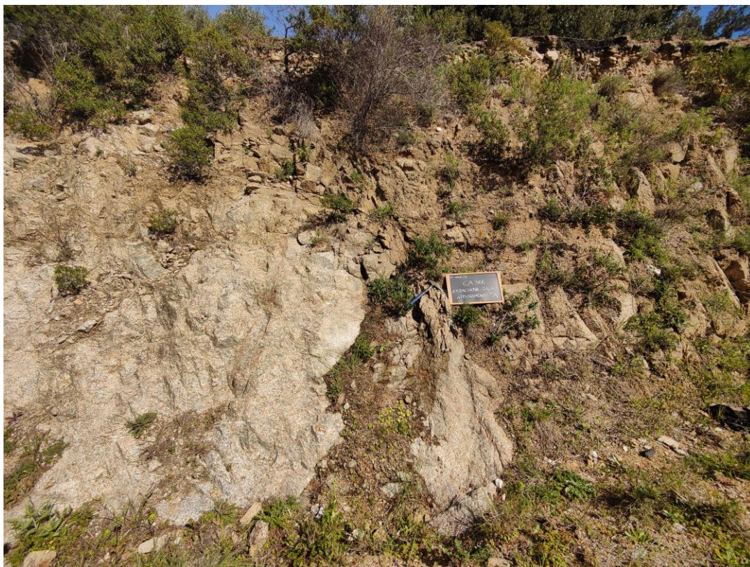
Fig. 5.4 - Particolare dell'affioramento presente fra le progressive chilometriche di progetto 1+840,00 e 1+960,00 (foto del 21/03/2023). Monzograniti, Facies Arzachena.
