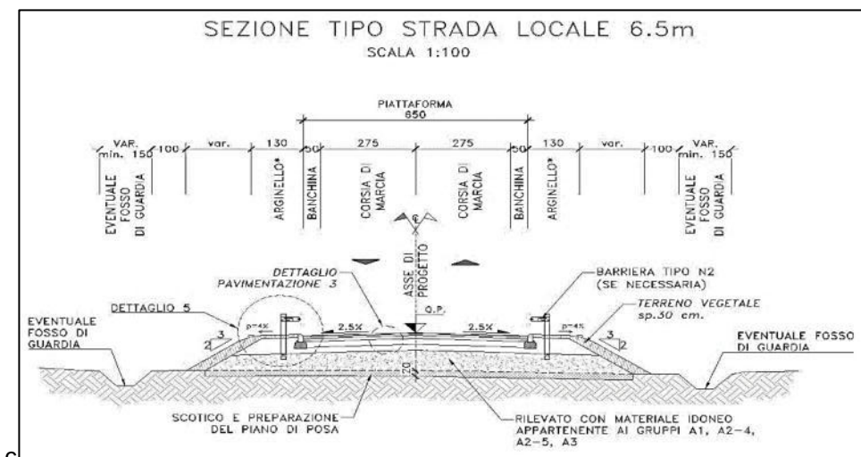
Figura 11. Sezione tipo strada secondaria tipo 2.
