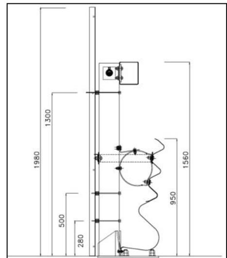
Con riferimento all'installazione della barriera di sicurezza H4b bordo ponte di cui sopra, si precisa che, non essendo consentito il collegamento diretto tra barriere che differiscono tra loro di due classi di contenimento, è stata prevista l'installazione di barriere H3BL (tipo ANAS) tampone tra la suddetta H4b e la H2BL corrente. Per maggiori dettagli si consultino gli elaborati grafici.
