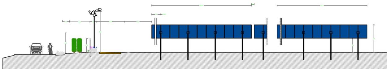
Figura 2: Vista frontale della struttura di supporto dei moduli
