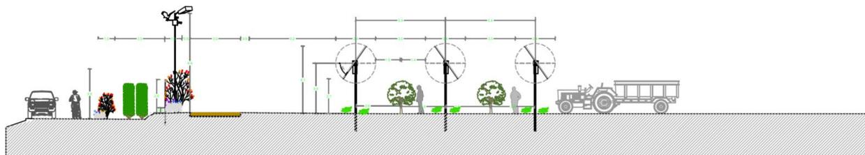
Figura 1: Vista in sezione delle strutture di supporto dei moduli con quotatura
