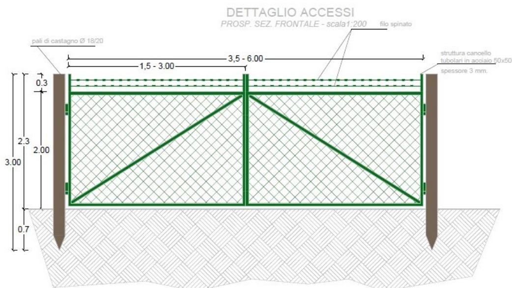
Figura 5: Prospetto della recinzione (dettaglio cancello di ingresso)
