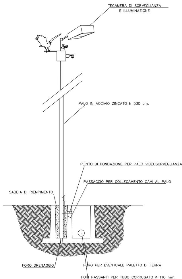
Figura 3: Vista laterale della struttura del palo di illuminazione e di videosorveglianza
