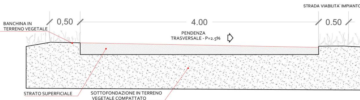
Figura 8: Sezione della strada interna.
