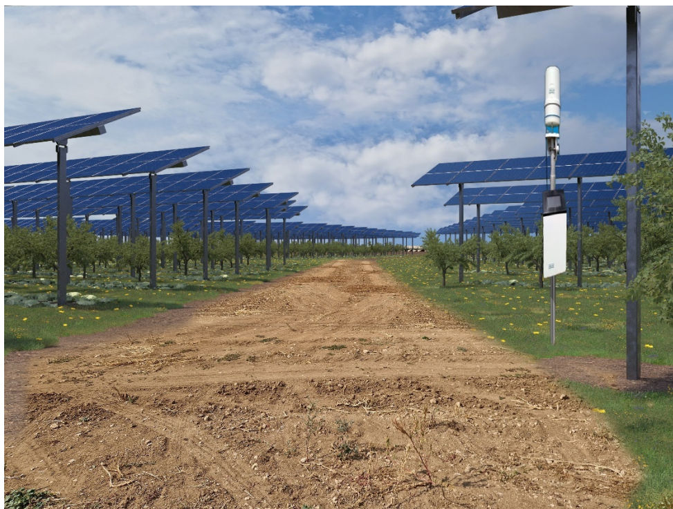
Figura 34 – Esempio di Stazione meteo ARMOS41 e Datalogger ZL6
