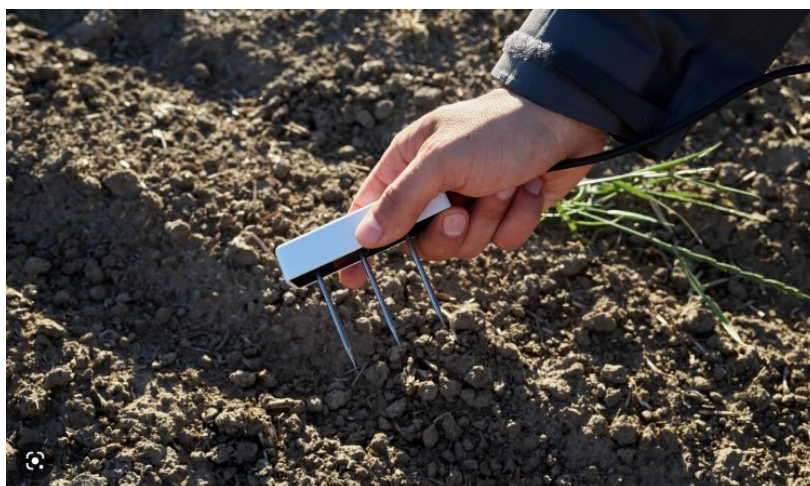
Figura 46 - Esempio di Sensore TERO12 (Meter) da inserire per il monitoraggio della coltivazione del mandorlo e delle colture ortive
