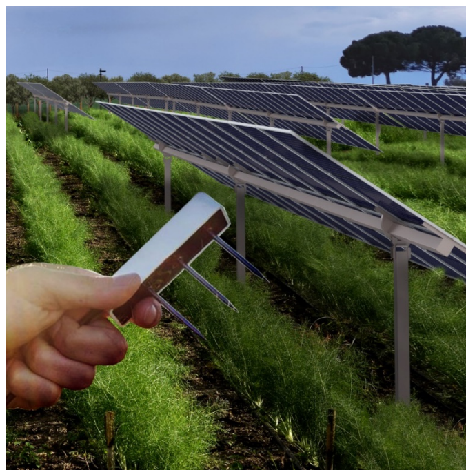
Figura 48 – Esempio di Sensore TEROS12 (Meter) da inserire per il monitoraggio delle colture ortive presenti al di sotto dei moduli
