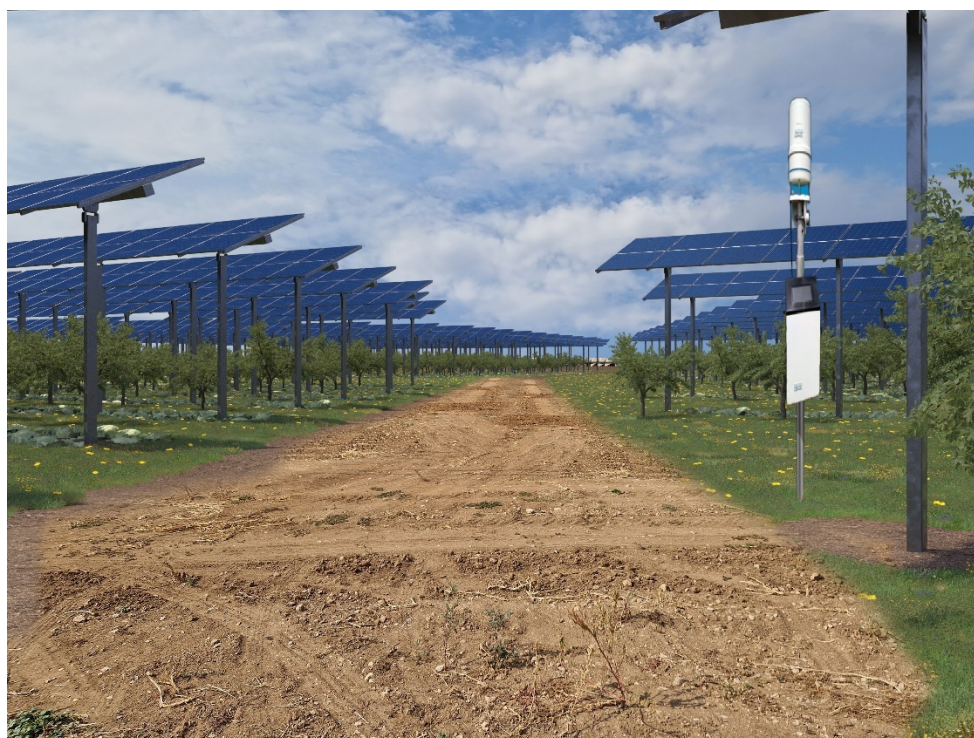
Figura 45 - Esempio di Stazione meteo ATMOS41 + datalogger ZL6 (Meter) con due sensori di PAR, da inserire in pieno campo
