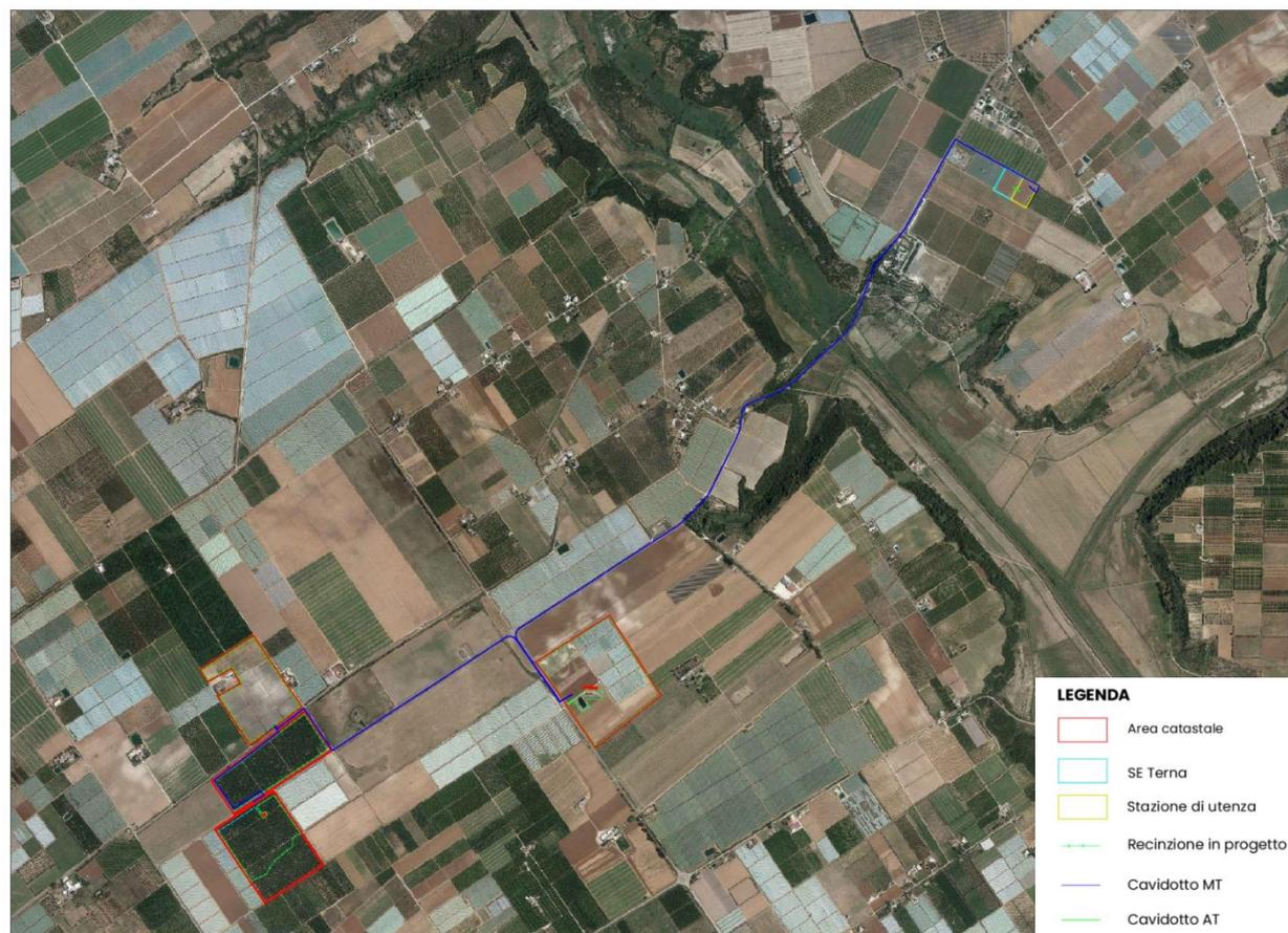
Figura 5 - Inquadramento su base ortofoto dell'impianto, del cavidotto, della stazione di elevazione di nuova realizzazione e della nuova SE
