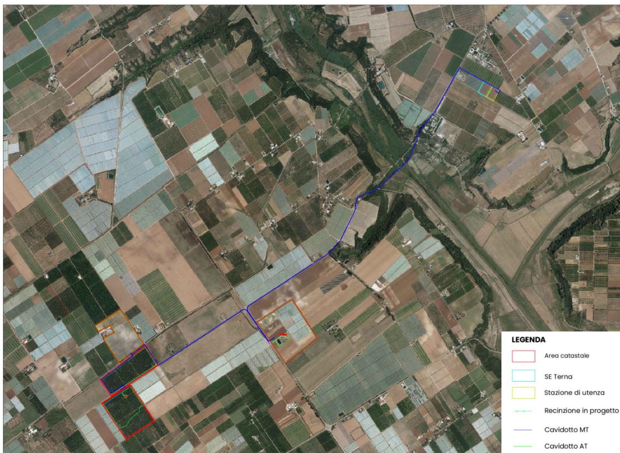
Figura 4: Inquadramento su base ortofoto dell'area di intervento comprendente l'area catastale (in rosso), l'area recintata (in verde), il cavidotto (in blu) e la cabina di elevazione (in giallo)
