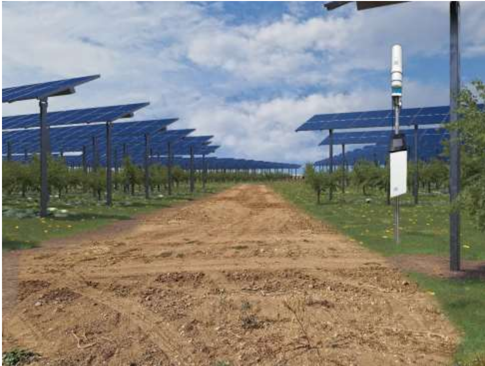
Figura 132: Esempio di Stazione meteo ATMOS41 + datalogger ZL6 (Meter) con due sensori di PAR, da inserire in progetto
