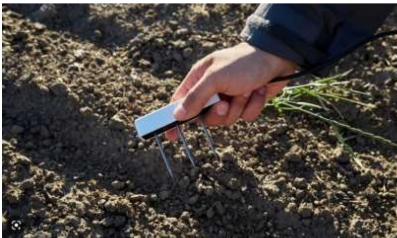
Figura 133 - Esempio di Sensore TEROS12 (Meter) da inserire per il monitoraggio della coltivazione del mandorlo e delle colture ortive
