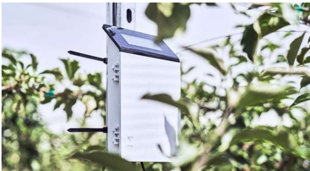
Figura 131: Esempio di Datalogger ZL6 (Meter) con 6 canali di ingresso, da inserire in pieno campo
