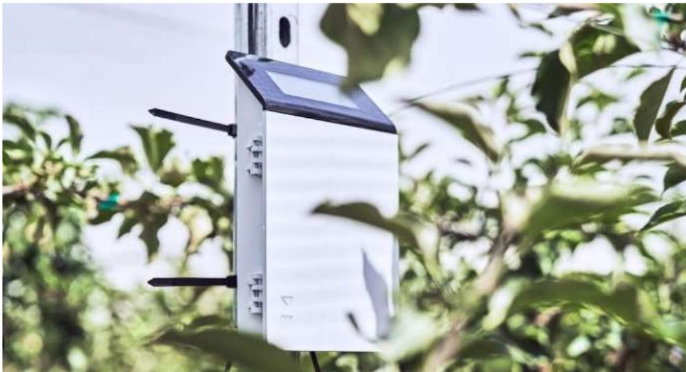
Figura 43 - Datalogger ZL6 (Meter) con 6 canali di ingresso, da inserire in pieno campo
