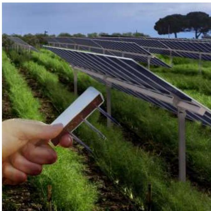
Figura 47 - Esempio di Sensore TEROS12 (Meter) da inserire per il monitoraggio delle colture ortive impiantate al di sotto dei moduli
