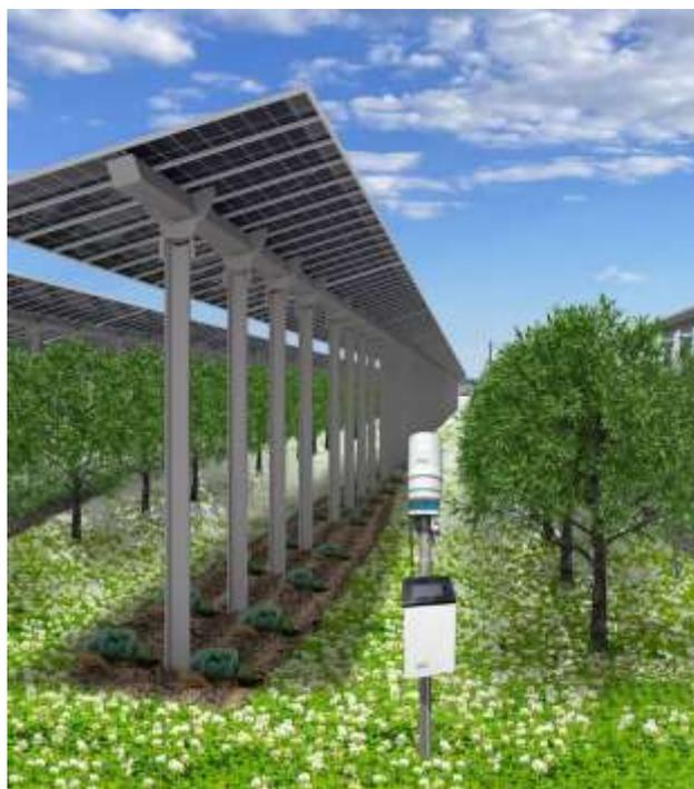
Figura 44 – Esempio di Stazione meteo ATMOS41 + datalogger ZL6 (Meter) con due sensori di PAR, da inserire in progetto
