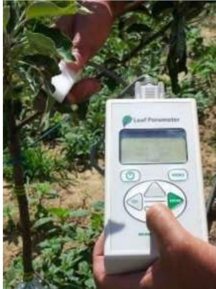
Figura 48- Esempio di Sensore LEAF-POROMETER utilizzato per i mandarini
