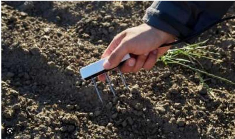
Figura 45 - Esempio di Sensore Teros12 (Meter) da inserire per il monitoraggio della coltivazione del mandorlo e delle colture ortive
