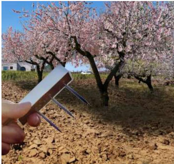
Figura 46 - Esempio di Sensore Teros12 (Meter) da inserire per il monitoraggio delle colture impiantate tra le interfile dei tracker
