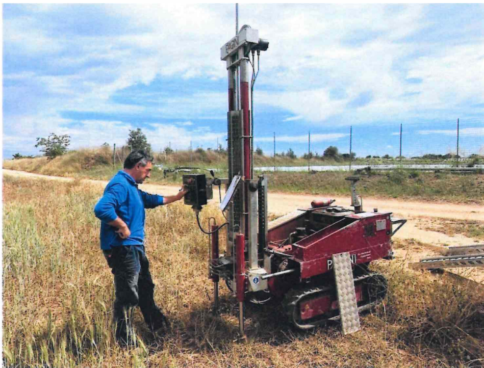
Esecuzione prova penetrometrica DPSH 7
