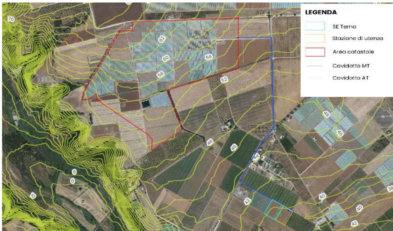
Figura 1: Curve di livello con dettaglio 1 m sovrapposte all'area di intervento su base ortofoto
