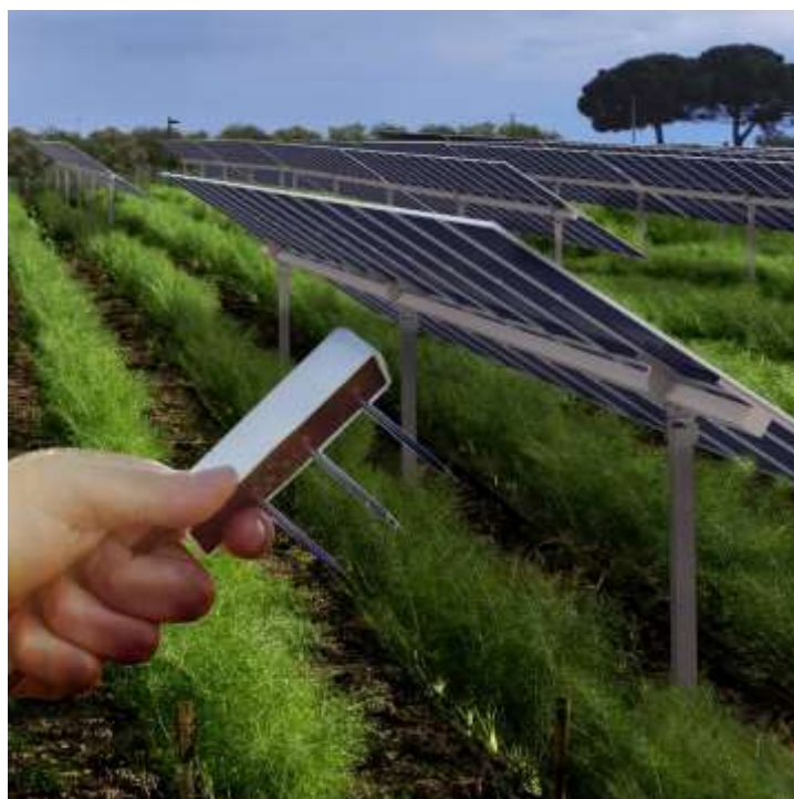
Figura 132: Esempio di Sensore TEROS12 (Meter) da inserire per il monitoraggio delle colture ortive piantate al di sotto dei moduli
