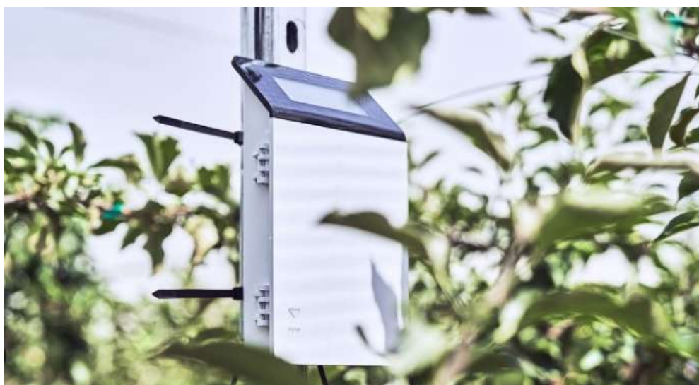
Figura 128: Esempio di Datalogger ZL6 (Meter) con 6 canali di ingresso, da inserire in pieno campo
