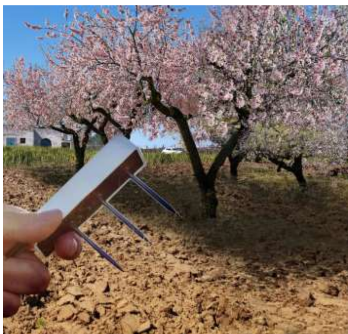
Figura 131: Esempio di Sensore TEROS12 (Meter) da inserire per il monitoraggio delle colture impiantate tra le interfile dei tracker
