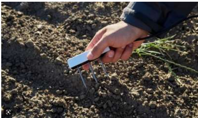
Figura 130: Esempio di Sensore TEROS12 (Meter) da inserire per il monitoraggio della coltivazione del mandorlo e delle colture ortive
