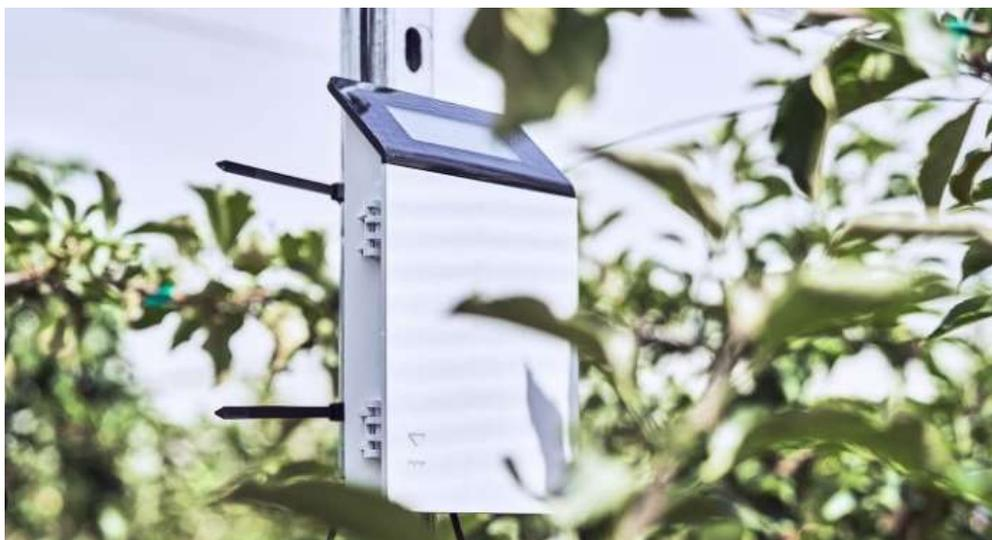
Figura 2 – Esempio di Datalogger ZL6 (Meter) con 6 canali di ingresso, da inserire in pieno campo
