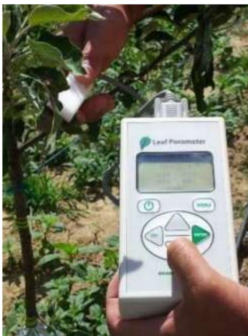
Figura 7 - Esempio di Sensore LEAF-POROMETER della coltivazione di mandorlo
