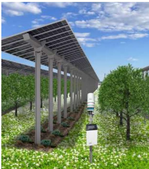
Figura 3– Esempio di Stazione meteo ATMOS41 + datalogger ZL6 (Meter) con due sensori di PAR, da inserire in progetto
