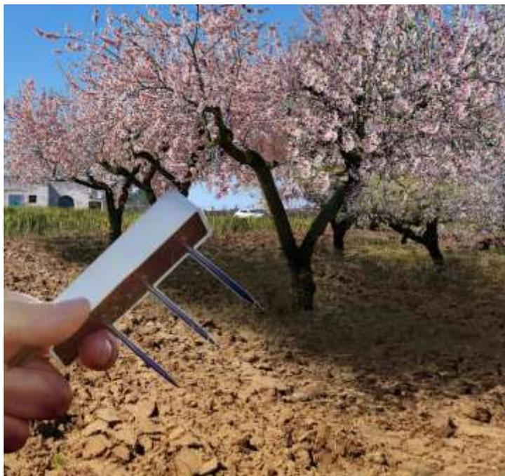
Figura 5 - Esempio di Sensore TEROS12 (Meter) da inserire per il monitoraggio delle colture impiantate tra le interfile dei tracker
