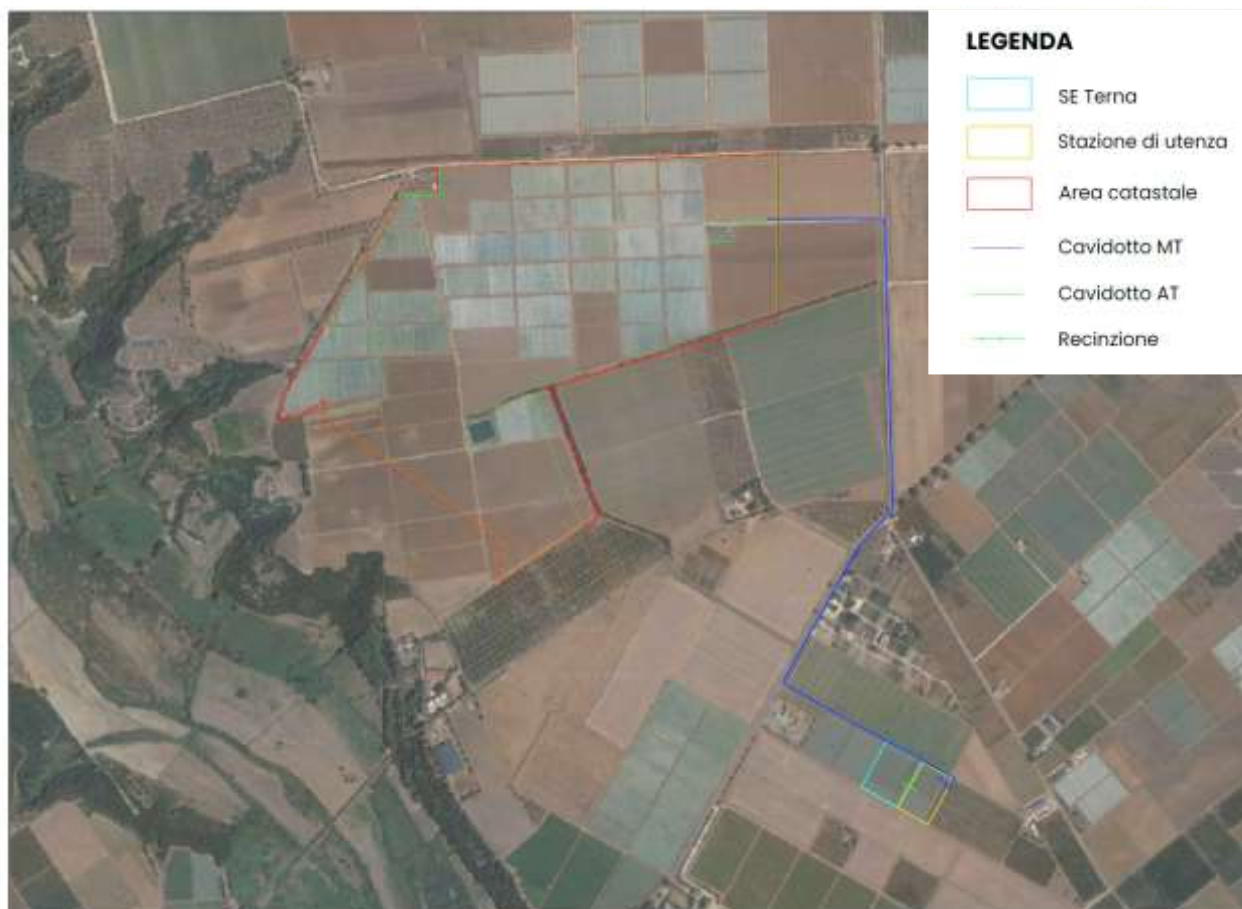
Figura 4: Stralcio ortofoto con individuazione della stazione di elevazione e di smistamento di nuova realizzazione
