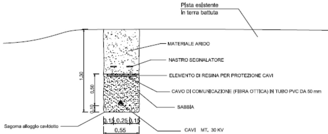
*Figura 6: Sezione di scavo per la posa del cavidotto su strada esistente*
