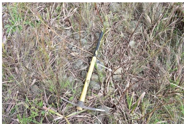
Figura 3.24– Rocciosità e pietrosità superficiale rilevate all'interno delle prospettate fondazioni
