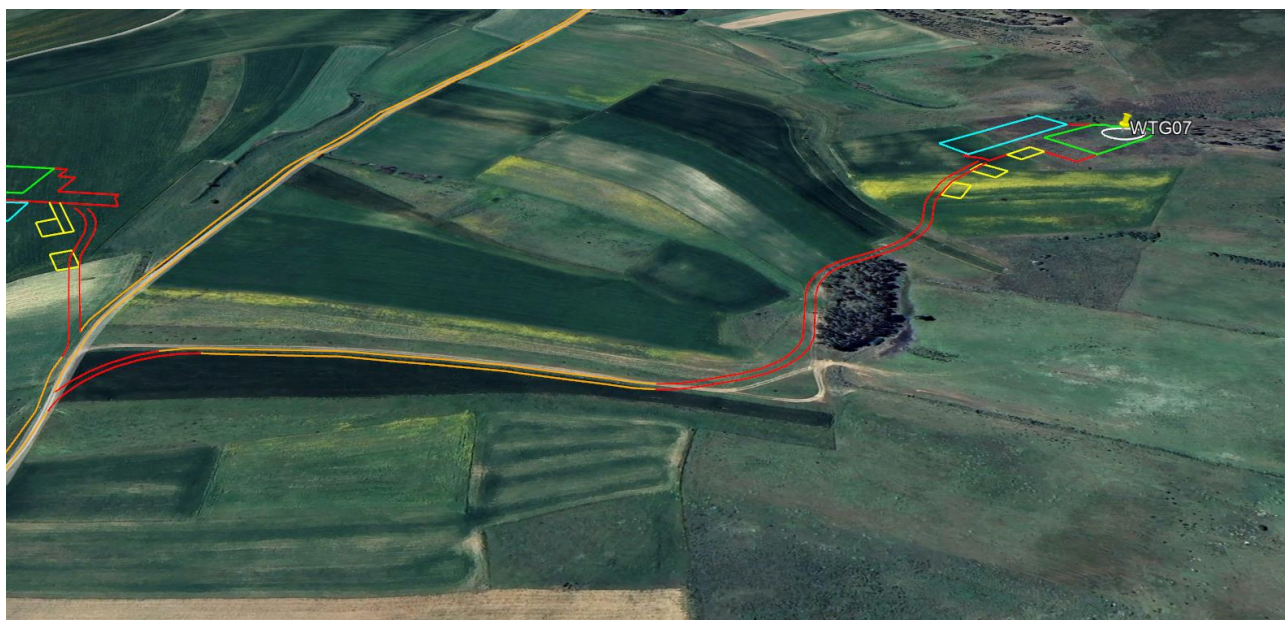
Figura 5.24 – Tracciato in adeguamento e di nuova costruzione di collegamento alla postazione eolica WTG07 (vista verso ovest)
