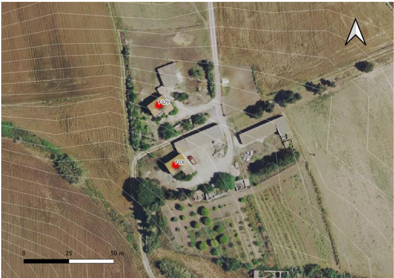
Figura 6.3 – Ricettori F 29 e F30 (Vista zenitale) e isolinee d’ombra (in bianco). In evidenza le alberature schermanti a bordo lotto, a sudovest dei fabbricati
