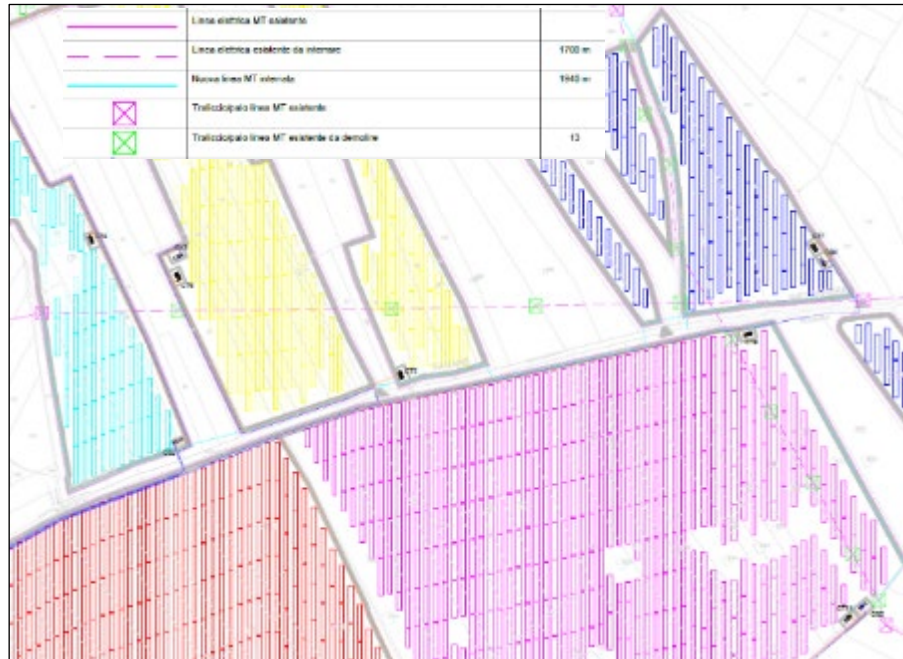
Figura 7 - Linea elettrica aerea soggetta ad interrimento (estratto da AVCALT-T009.1 -Tavola delle interferenze con Opere Infrastrutturali.pdf)
