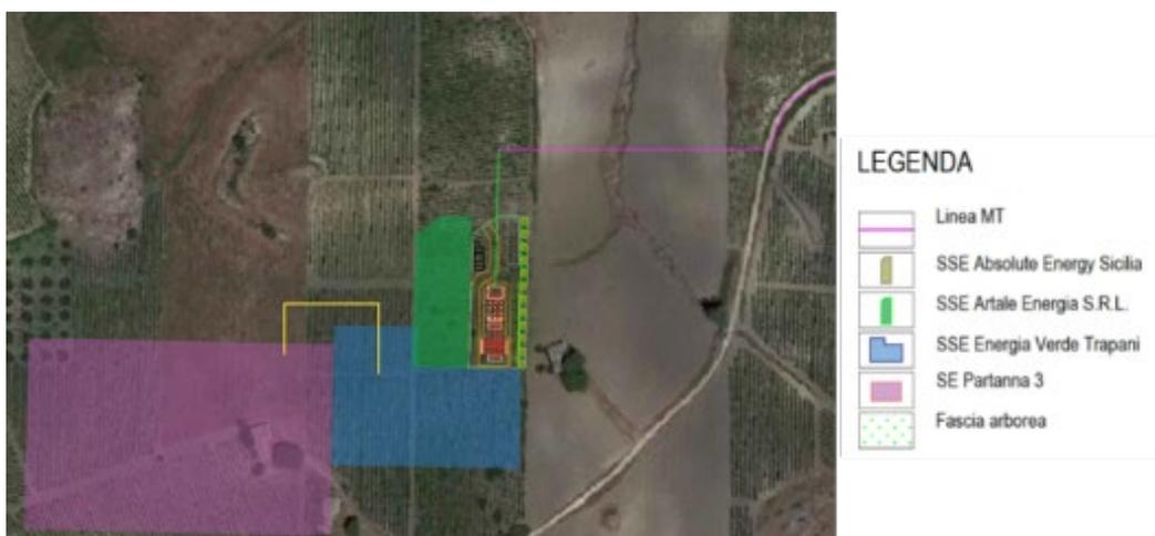
Figura 10. Dettaglio SSE MT/AT su base ortofoto<sup>18</sup>. In verde e viola Cavidotto MT
