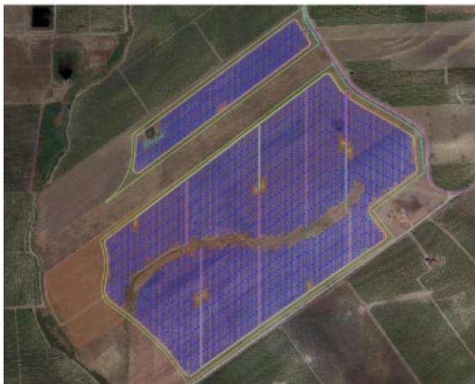
**Figura 7.** Inquadramento su Ortofoto, layout impianto agrovoltaiico, disposizione tracker, cabine, viabilità, fasce di rispetto da impluvi - Esempio sottocampo 5<sup>10</sup>
