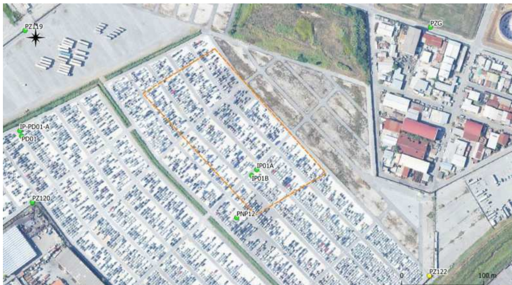
Figura 32 - Piezometri di monitoraggio presso l'area di stoccaggio materiali di scavo Ecofining+SR.
