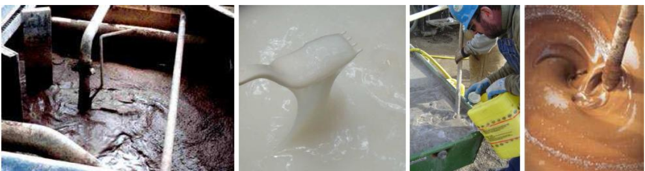
Figura 71 – Esempi di fanghi e fluidi perforanti usati per le operazioni di scavo e di formazione dei pozzi petroliferi [fonte: M.R. D’Orsogna]
