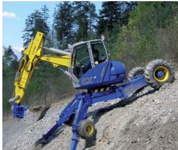
Figura 17: esempio escavatore tipo ragno
