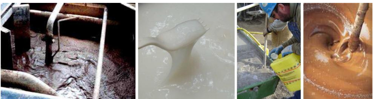
Figura 71 – Esempi di fanghi e fluidi perforanti usati per le operazioni di scavo e di formazione dei pozzi petroliferi [fonte: M.R. D’Orsogna]
